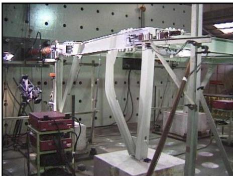
図一4 モデルのブレース座屈
