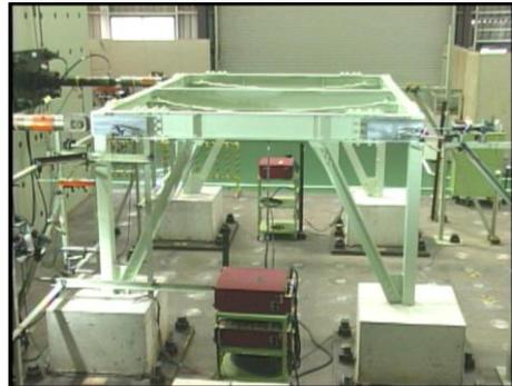
図一3 静的荷重載荷試験
